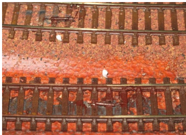
Reedkontakter monteret mellem skinnerne. Under hvert lokomotiv blev monteret en lille magnet.
